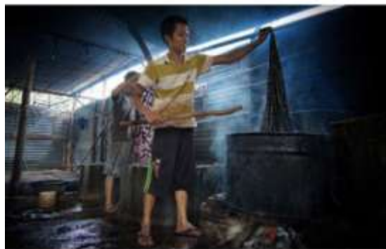
Gambar 2: Proses Pencelupan Kain Batik secara Manual setelah Proses Pemalaman
