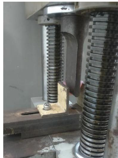
Gambar 2. Pengujian kekuatan transversa plat termoplastik nilon diuji hingga melengkung atau fraktur
