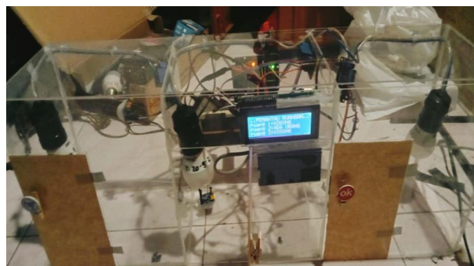
Gambar 8. Kondisi Ketika Sensor PIR Tidak Mendeteksi Objek
