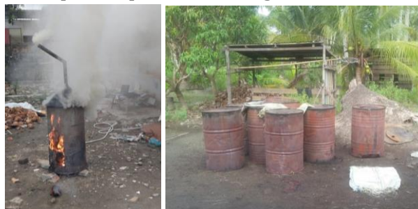
Gambar 3. proses pembuat arang secara konvensional
