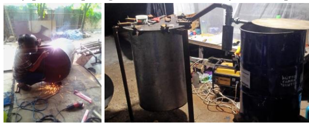
Gambar 8 a) proses pengelasan reaktor, b) mesin pengarangan
