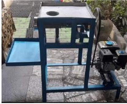
Gambar 3. Proses akhir pembuatan mesin penggiling daging ayam
