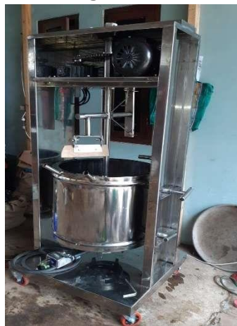
Gambar 3. Mesin Pengaduk Jahe Instan
