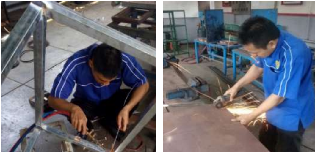
Gambar 5. Laboran dan dosen sedang membuat komponen dan rangka mesin pengaduk gula dengan hollow galvanis
