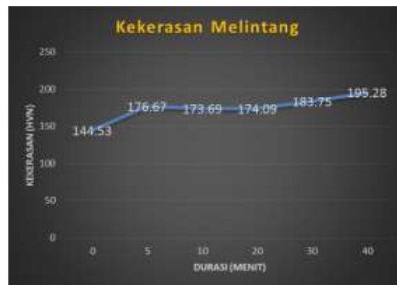
Gambar 5: Nilai Kekerasan Melintang Material ST 37 Pada Jarak 60 \mu\text{m}
