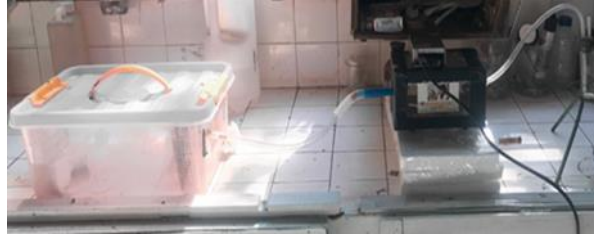
Gambar 1. Smoking box dan selang penghubung asap rokok
