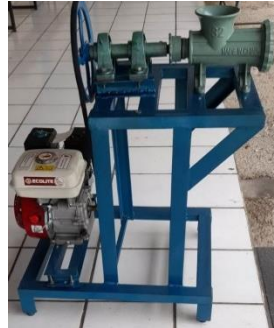
Gambar 3. Proses akhir pembuatan mesin penggiling ikan
