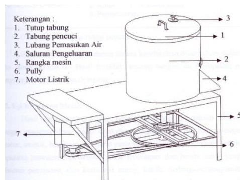
Gambar 1. Desain alat pencuci empon
