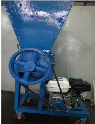
Gambar 1. Mesin Pencacah Plastik (sumber: dokumen pribadi)
