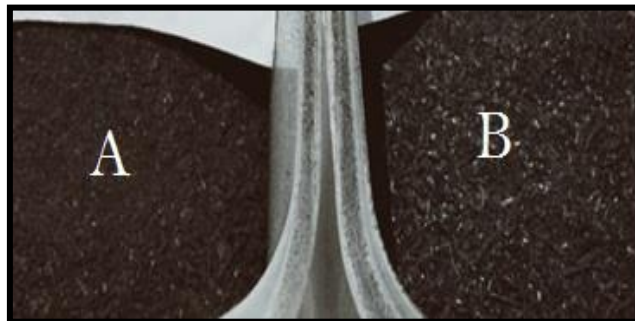
Gambar 2. Perbandingan ukuran arang, A) limbah baglog jamur tiram; B) sekam padi
