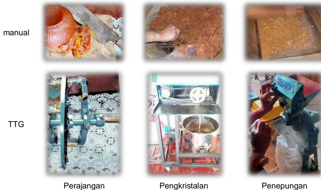
Gambar 2: Proses Pembuatan Gula Semut dengan Manual dan TTG
