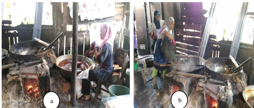
Gambar 1. Kondisi proses produksi gula merah (Gula Jawa) Di UD Sri Rejeki Desa Citepus, a. Pengadukan manual, b. Pembakaran dengan kayu
