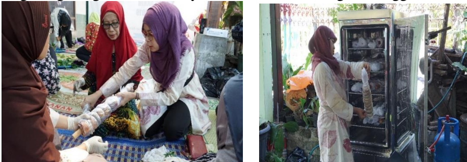
Gambar 4: Kain digulung dan ditali raffia lalu dimasukkan ke dalam mesin kukus
