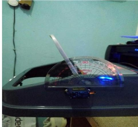
Adapun gambar saat pengukuran langsung dengan servo dengan menggunakan protractor(busur) yang di letakan pada poros tutup tempat sampah pada  $0^{\circ}$ . Terlihat pada gambar sudah sesuai dengan coding pada arduino yaitu sebesar  $60^{\circ}$ .
